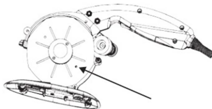
Шаг второй: Используя шестигранный ключ, вставьте его в лезвие, затем при помощи гаечного ключа в форме «бабочки» отвинтите лезвиеприжимные пластины против часовой стрелки.
