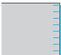
Проходя углы, останавливайте машину с иглой, опущенной рядом с аппликацией, поднимайте прижимную лапку, и поворачивайте материал, как это необходимо, чтобы изменить направление шитья.
